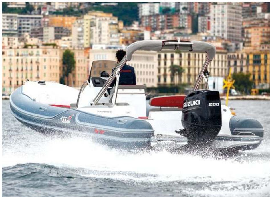
Il nuovo motore è un 4 cilindri in linea e pesa 226 kg. Risulta così meno ingombrante di un classico V6.
